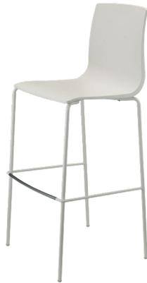
Sgabello con scocca in tecnopolimero riciclabile. Struttura a 4 gambe in acciaio tubolare ø mm 16 verniciato, disponibile in due altezze. A richiesta sono disponibili ganci di collegamento in acciaio cromato per comporre file di sgabelli. Per uso interno/esterno.
